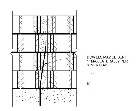
TYP MASONRY DOWEL POSITION TOLERANCE SCALE: N.T.S.
