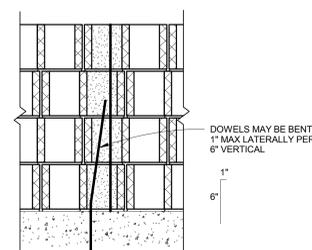
5 TYP MASONRY DOWEL POSITION TOLERANCE
