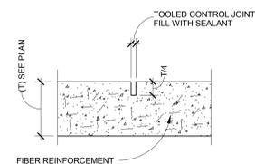
6 TYP CONTROL JOINT SLAB ON GRADE
